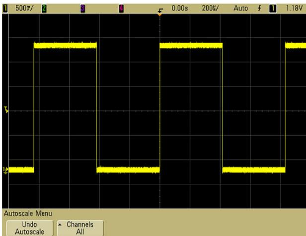
波形は表示されるが、方形波の形が上記と違っている場合は、「[オシロスコープ・プローブを補正するには](#)」(37ページ)の手順を実行します。
